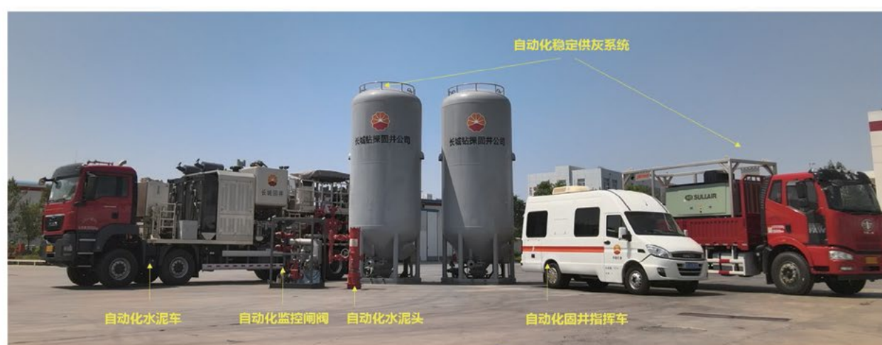
全新一代成套自动化固井作业装备
