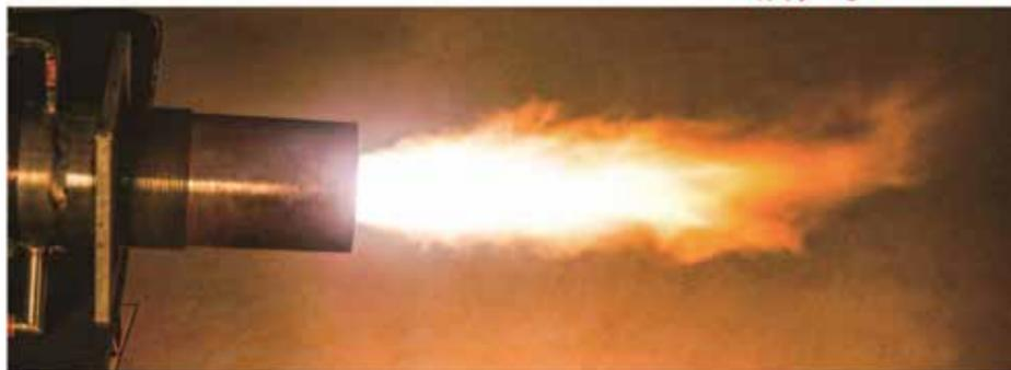
热等离子体处理危险废物的独特处理方法表现出安全、高效、无二次污染和广泛适用性,等离子体技术为危险废物及工业固体废物的无害化、减量化和资源化回收提供了一个十分科学有效的方法。
