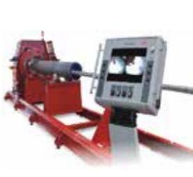
长管内壁自动堆焊系统
