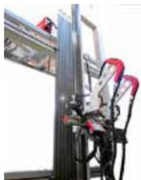
膜式壁自动堆焊系统
